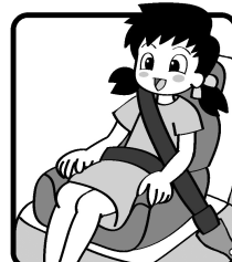
*学童用シート (ジュニアシート)・・・ 体重 15 kg～32 kg程度 年齢 4～10歳程度
